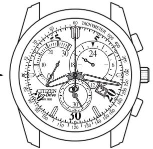
La manecilla de segundos comienza a moverse en intervalos de 2 segundos, cuando el reloj es cargado permitiendo que la luz incida sobre la celda solar. Sin embargo, como el reloj se ha parado como resultado de estar con una carga insuficiente, la hora no está correcta. Cargue suficientemente el reloj hasta que la manecilla de segundos comience a moverse en intervalos de 1 segundo, y luego reposicione la hora antes de usar el reloj.
