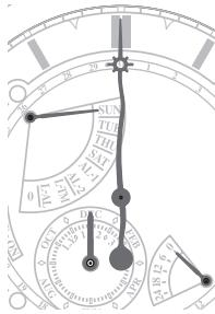
目前基準位置與正確位置不同時，按照「校正基準位置」的步驟調整位置。
