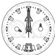
Wenn sich die aktuelle Bezugsposition von der korrekten Position unterscheidet, passen Sie die Position wie unter **Korrigieren der Bezugsposition** beschrieben an.
