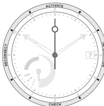
Indicação de conexão pelo ponteiro dos segundos
