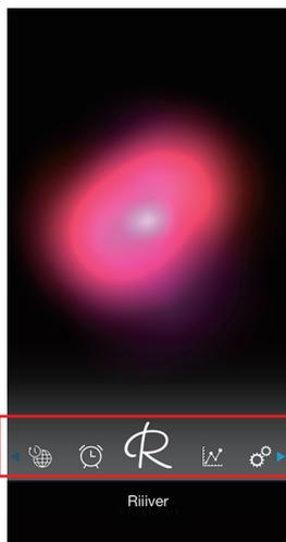
Este patrón gráfico en la pantalla representa la cantidad de energía generada por el reloj conectado. El patrón de la imagen significa que la cantidad de generación de energía está prácticamente al máximo y que el reloj se está cargando de forma óptima.
