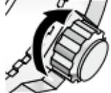
Introduzca la corona en la caja. Gire la corona en sentido horario mientras la presiona levemente contra la caja para asegurarla. Asegúrese de apretarla firmemente.<br><i>Diagrama: Muestra la corona siendo insertada y girada. Una flecha curva indica la rotación horaria.</i> |
