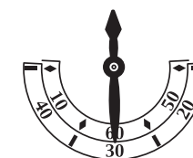
Indicador del extremo largo de la manecilla de segundos de 15 a 45 segundos
