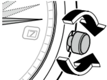
Drehen Sie zur Minuteneinstellung den Minutenzeiger um 5 Minuten über die korrekte Zeit hinaus und bewegen Sie ihn dann wieder zur richtigen Minute zurück. Dadurch verringert sich die Anzeigetoleranz und die Zeigerbewegung wird präziser.
