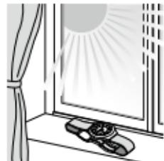
Beim Tragen von Kleidung, welche die Uhr verdeckt, erhält die Vorderseite der Uhr nicht genügend Licht, sodass sie nur unzureichend aufgeladen wird.
