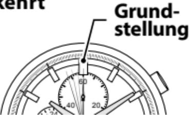
Während der Ausrichtung an der Grundstellung wird die Zeit angehalten. Stellen Sie anschließend die Zeit ein.
