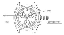
若手錶的把的設有螺絲,請向左扭鬆後,再進行設定操作。設定完畢後,請將 把的按回原位並將螺絲向右扭緊。
