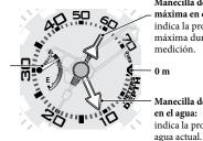
Manecilla de profundidad máxima en el agua: indica la profundidad máxima durante una medición.
